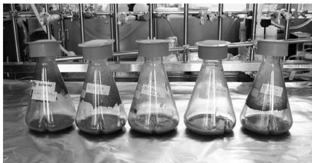
白色腐朽菌を用いた河川底泥の分解試験
