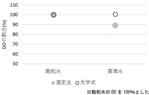
図6 濁度の違いによるDOの変化（高濁度）
