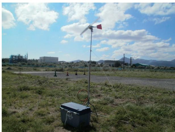
図 4 風力発電試験装置写真
