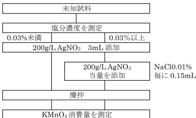
図4 KMnO<sub>4</sub>消費量の測定フロー
