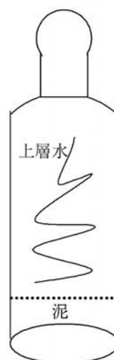
図2 溶出量試験に用いた容器の形状と条件
