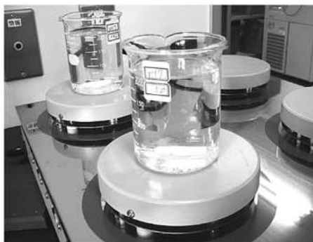
写真2 凝集沈殿ジャーテスト
