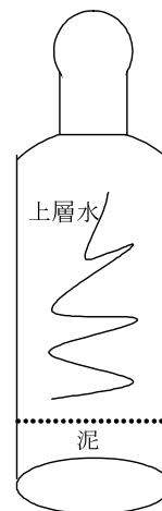
図2 溶出速度試験に用いた容器の形状と条件
