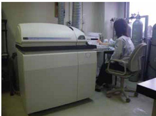
最近導入した ICP-MS 分析装置
