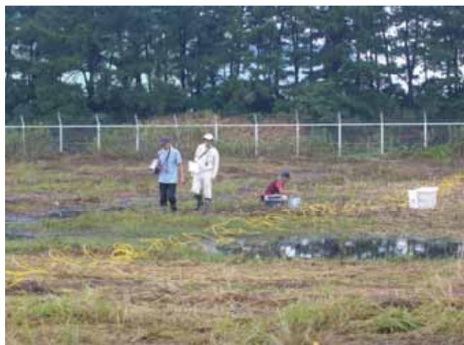
比抵抗探査（黄色のライン）と地表ガス噴出箇所調査
