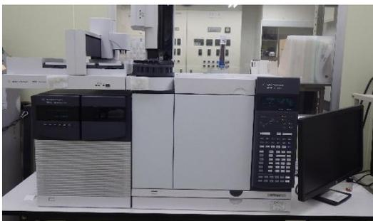
ガスクロマトグラフトリプル四重極型質量分析計 (GC/MS/MS)
