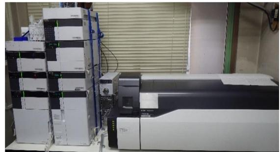
高速液体クロマトグラフ-タンデム質量分析計 (LC/MS/MS)
