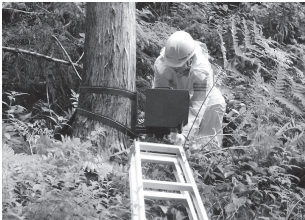
監視カメラの設置
