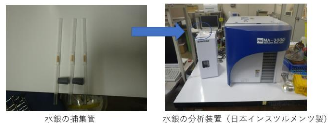
図2 水銀の捕集方法および分析装置
