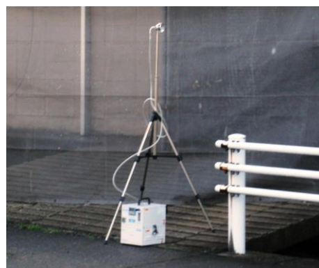
図2 大気の採取装置
